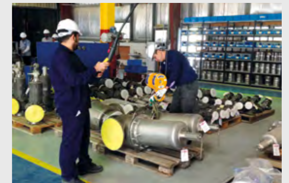
Binzagr Montage für LESER Sicherheitsventile in Saudi-Arabien
