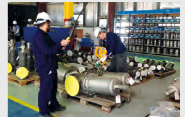
Montagem na Binzagr para válvulas de segurança LESER na Arábia Saudita
