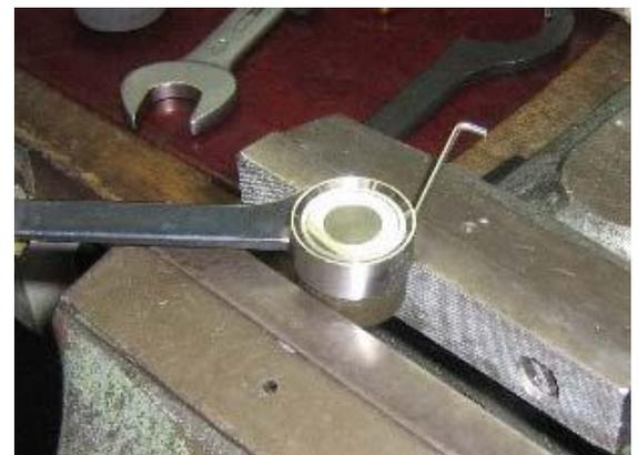
Abb.4 Montage des Sicherungsringes
