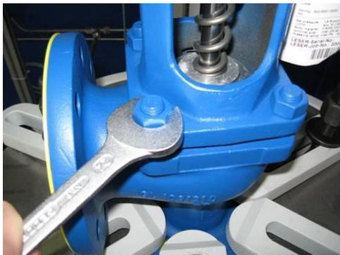
Abb.1 Lösen der Verschraubung
