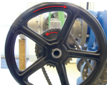
Drehrichtung von Hand- und Kettenrad (Die Kette wird bei der Montage angebracht). Vgl. Schritt 2 aus der Vorgehensweise.
