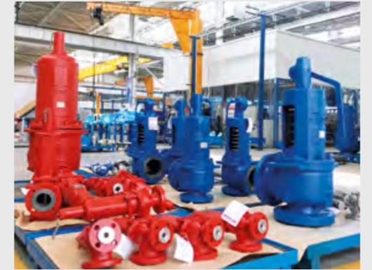
Предохранительные клапаны LESER местного производства
