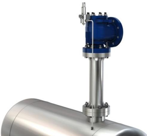
Nesse caso, o *tubing*, que por padrão é interligado entre a entrada da válvula no piloto e domo, é retirado e o mesmo é interligado entre o equipamento a ser protegido diretamente no piloto/domo e, com isso, “eliminando” a perda de carga existente entre o equipamento a ser protegido e a entrada da válvula.
