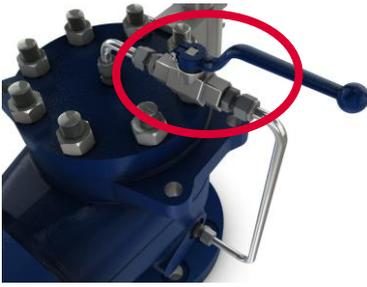
É instalada uma válvula esfera na tampa para que a pressão do domo seja aliviada para a saída e assim fazendo a movimentação do pistão.
