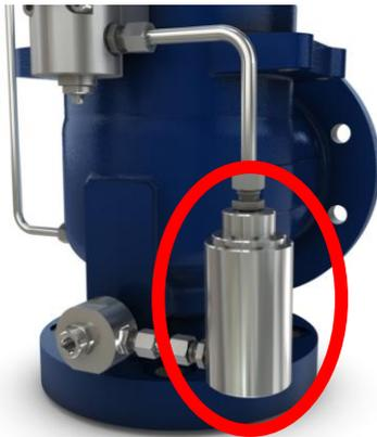
O próximo componente que podemos ter para esse tipo de válvula é o **Filtro** na linha de alimentação do Piloto, que é bastante utilizado para quando temos particulados no fluido que podem fazer com que não tenhamos o bom funcionamento do piloto.
