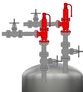
Para os casos onde a válvula de troca é utilizada, existe outra alternativa que são duas válvulas de bloqueio (que não restrinja a passagem do fluxo) com ou sem um sistema de intertravamento para que se garanta que tenha sempre uma válvula protegendo o sistema. Em ambos os casos, há uma probabilidade de erro humano e assim que tenhamos o sistema desprotegido, ocasionando um possível acidente.
