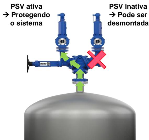
Normas e regulamentações como o ASME Sec. VIII Div. 1 UG-156 ou AD2000- Merkblatt A2 Par.6 exigem que: em casos onde tiver mudança de válvulas para proteção, pelo menos uma das seções transversais estejam livre para proteção do processo a todo tempo. Além disso, as normas exigem que a seção circular da válvula de bloqueio seja maior do que o orifício da válvula, assim não há risco de redução de vazão devido a esse possível estrangulamento da linha.
