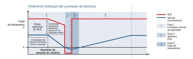
Assim, sempre que houver necessidade de trabalhar com pressões de operação mais próximas a pressão de abertura ou a necessidade que a válvula atue e libera a vazão em um tempo curto, pode-se usar o SLS.
