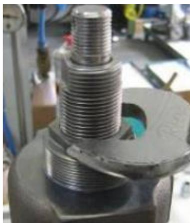
Como característica, todas as válvulas da LESER onde há a necessidade de aperto do componente, tem o lugar apropriado para colocação da chave específica a fim de não termos dano ao componente.
