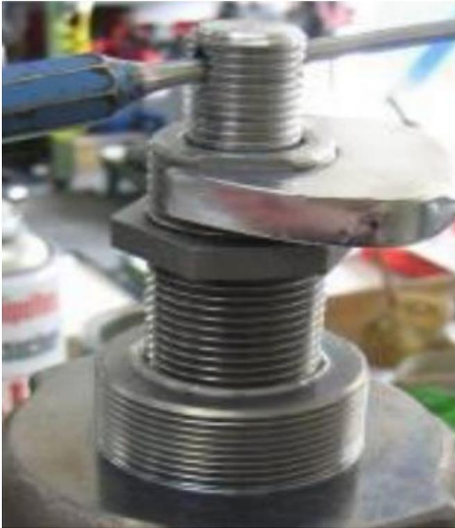
O primeiro cuidado a ser tomado numa desmontagem é que a pressão da mola via parafuso de regulagem tenha sido zerado pois em casos que ainda há a pressão da mola na retirada dos parafusos do castelo, o mesmo pode catapultar para cima, com risco de acidente para o operador.
