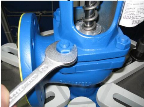
Abb.1 Lösen der Verschraubung
