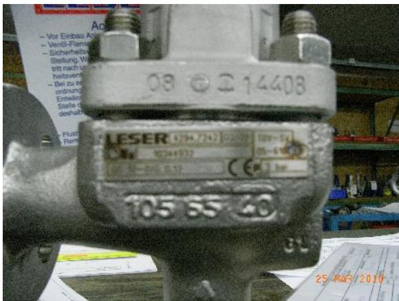
Abbildung 6.2.1-6: Standardschild am Flanschventil
