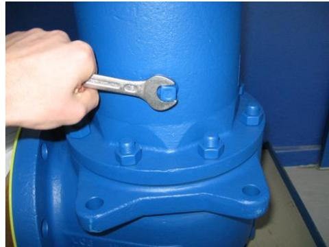
Abb.2 Verschließen der Entwässerungsbohrung
