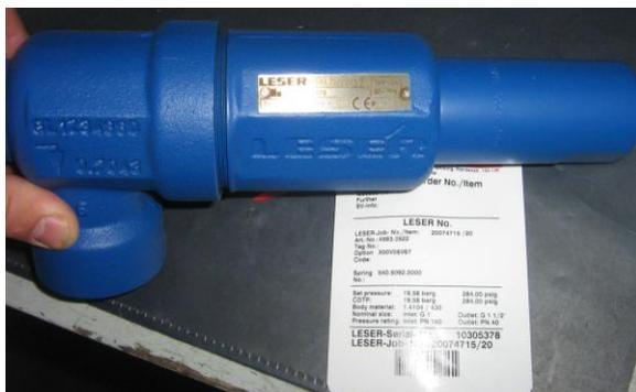
Abbildung 7.1-2: Kontrolle der Typnummer gegen den Ventilprüfplan / Reparaturauftrag
