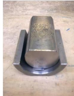
Das Typenschild wird mit der Beschriftung nach unten in Längsrichtung (siehe Abbildung) in die Matrize gelegt. Es wird manuell (ohne Führung o. ä.) durch 2- bis 3-maliges Schlagen mit dem Stempel in die gewünschte Form gebracht.
