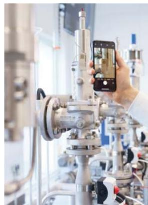
Die LESER Digital ID stellt eine digitale Schnittstelle dar, mit deren Hilfe der Nutzer mit jedem Smartphone direkt vom Sicherheitsventil auf die Webservices zugreifen kann. Foto: LESER GmbH & Co. KG
