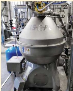
Der Separator RSI 170 von GEA wurde speziell für die Speiseölraffinerie entwickelt. Foto: Oliyar/GEA
