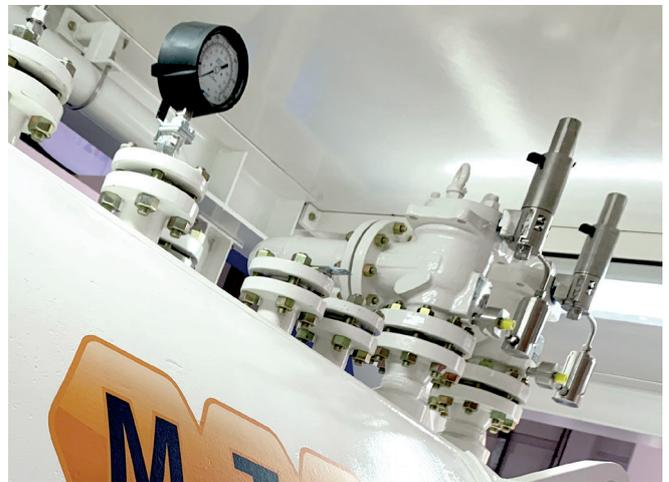
Höhe kann sogar noch weiter reduziert werden. Mit Hilfe eines Kompaktadapters, der zwischen Haupt- und Pilotventil montiert wird, wird das Pilotventil abgesenkt und die Höhe auf ein Minimum reduziert. In dem konkreten Beispiel sind das 392 mm.
